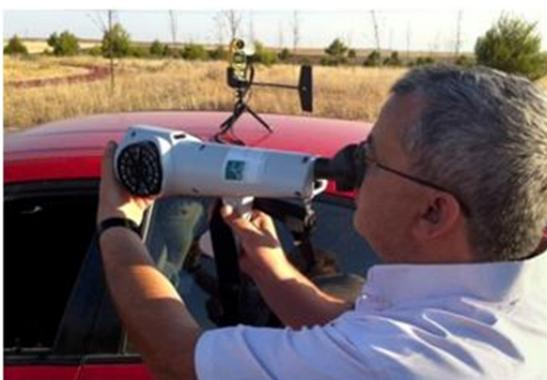
**Figura 3. Mediciones meteorológicas y olfatométricas simultáneas**
