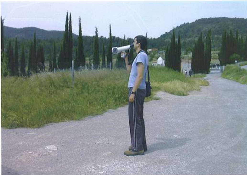
Figura 3. Medición en campo del nivel de concentración de olor en inmisión utilizando Nasal Ranger.
