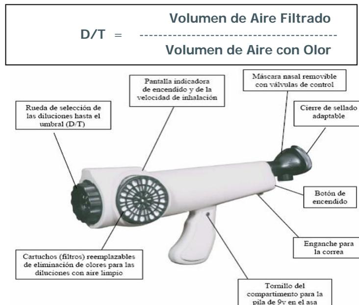
Figura 1. Diagrama de los componentes principales del Nasal Ranger™
