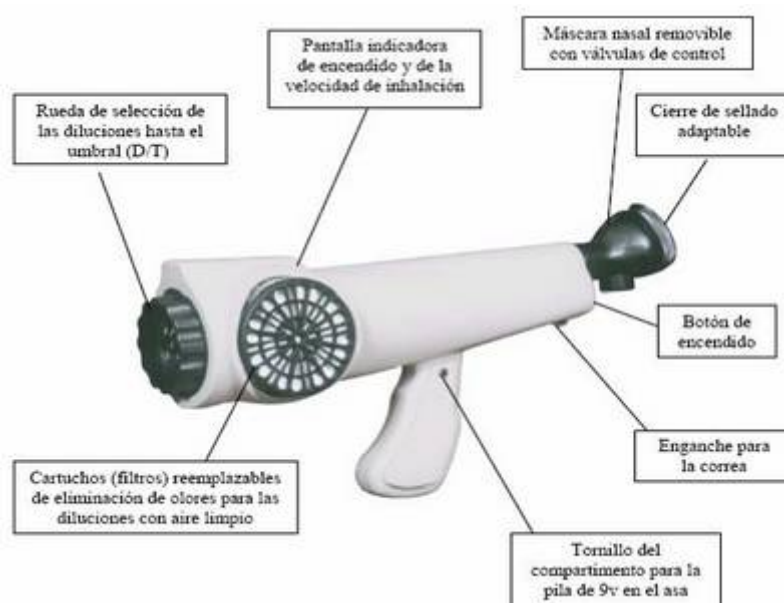
Figura 1. Diagrama de los componentes principales del Nasal Ranger™
