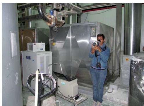
Figura 2. Olfatometría de campo con el Nasal Ranger®, mediciones in situ por panelistas calibrados de SADYT / Figure 2. Field Olfactometry with the Nasal Ranger®, in situ measurements with SADYT calibrated panellists.
