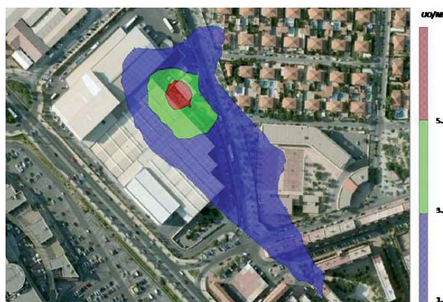
Figura 4. Modelización de las inmisiones EDAR i Helados Alacant. UNE-EN 13725 / Figure 4. Modelling of immissions at the Helados Alacant IWWTP. UNE-EN 13725
